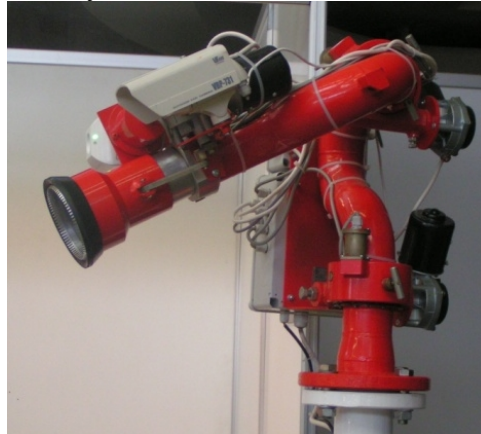
Obr. 2: Robotické protipožární rameno se třemi stupni volnosti
