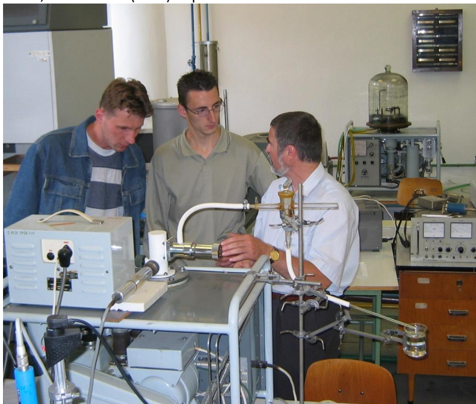
Karel Bok ještě v původní vakuové laboratoři připravuje účastníky kurzu na úlohu praktika č. 3 - Měření čerpací rychlosti difúzní vývěvy metodou stálého tlaku (červen 2005).
