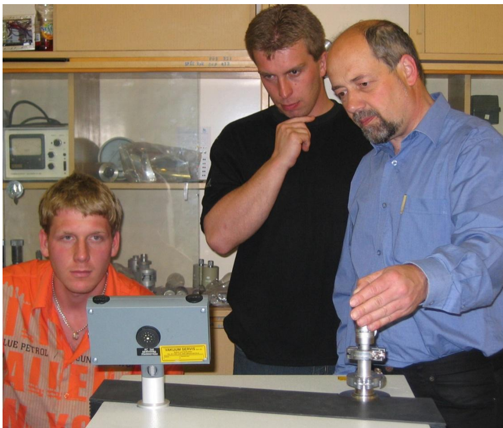
Jiří Kubáň předvádí účastníkům kurzu práci s héliovým hledačem netěsností (červen 2005).
